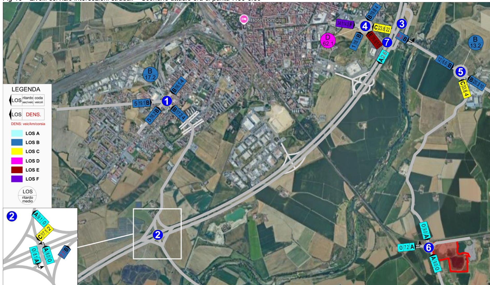
Fig 46 – Livelli servizio intersezioni stradali – Scenario attuale ora di punta 7.30-8.30
