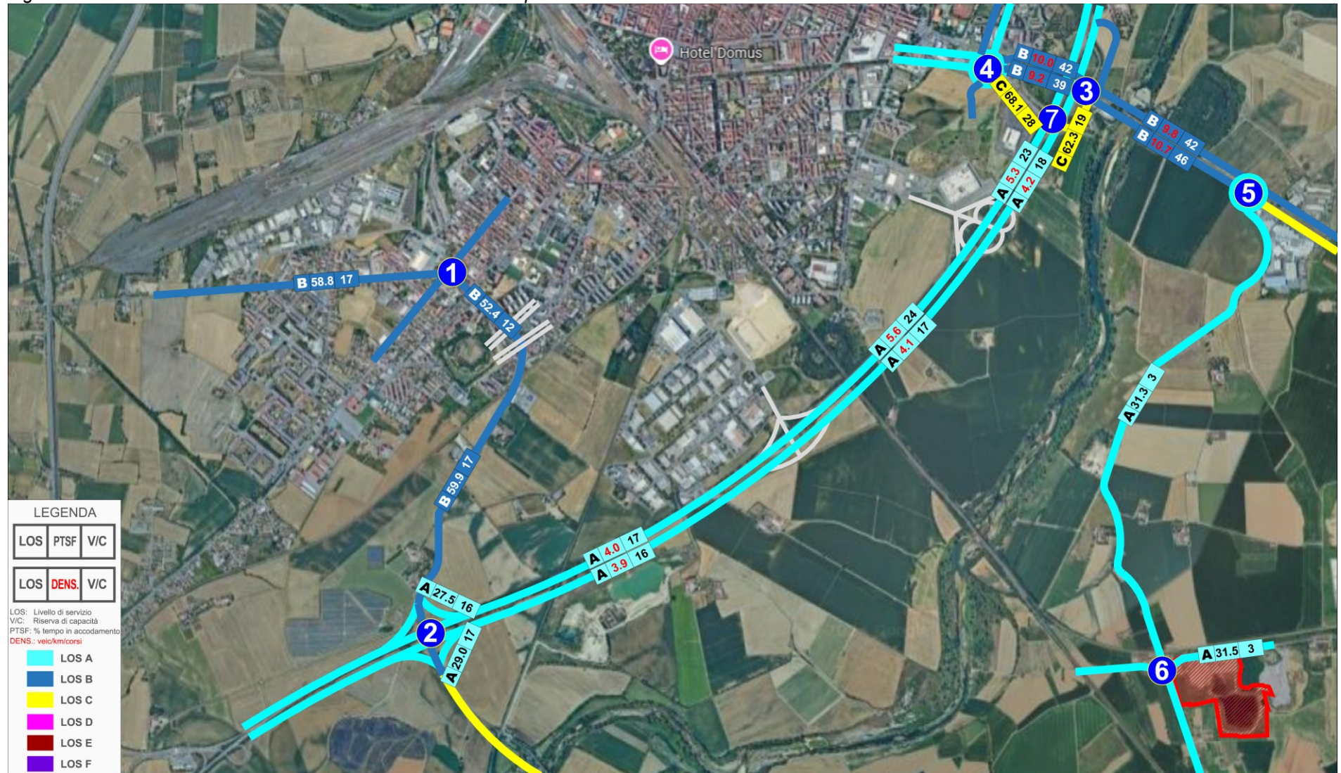
Fig. 40 – Livelli servizio rete stradale – Scenario attuale ora di punta 13.30-14.30
