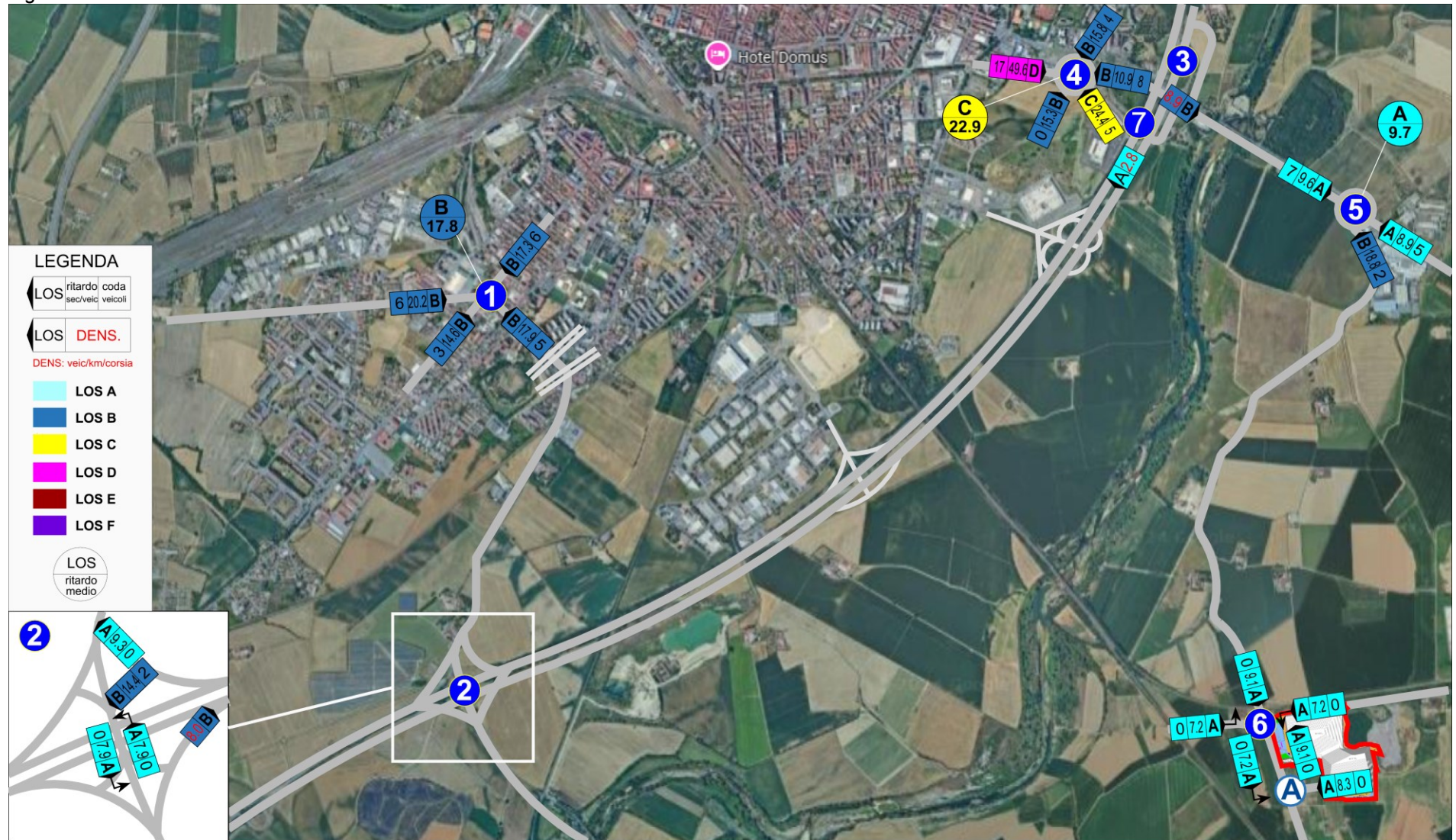
Fig. 72 – Livelli di servizio intersezioni– Scenario futuro ora di morbida 15.30-16.30
