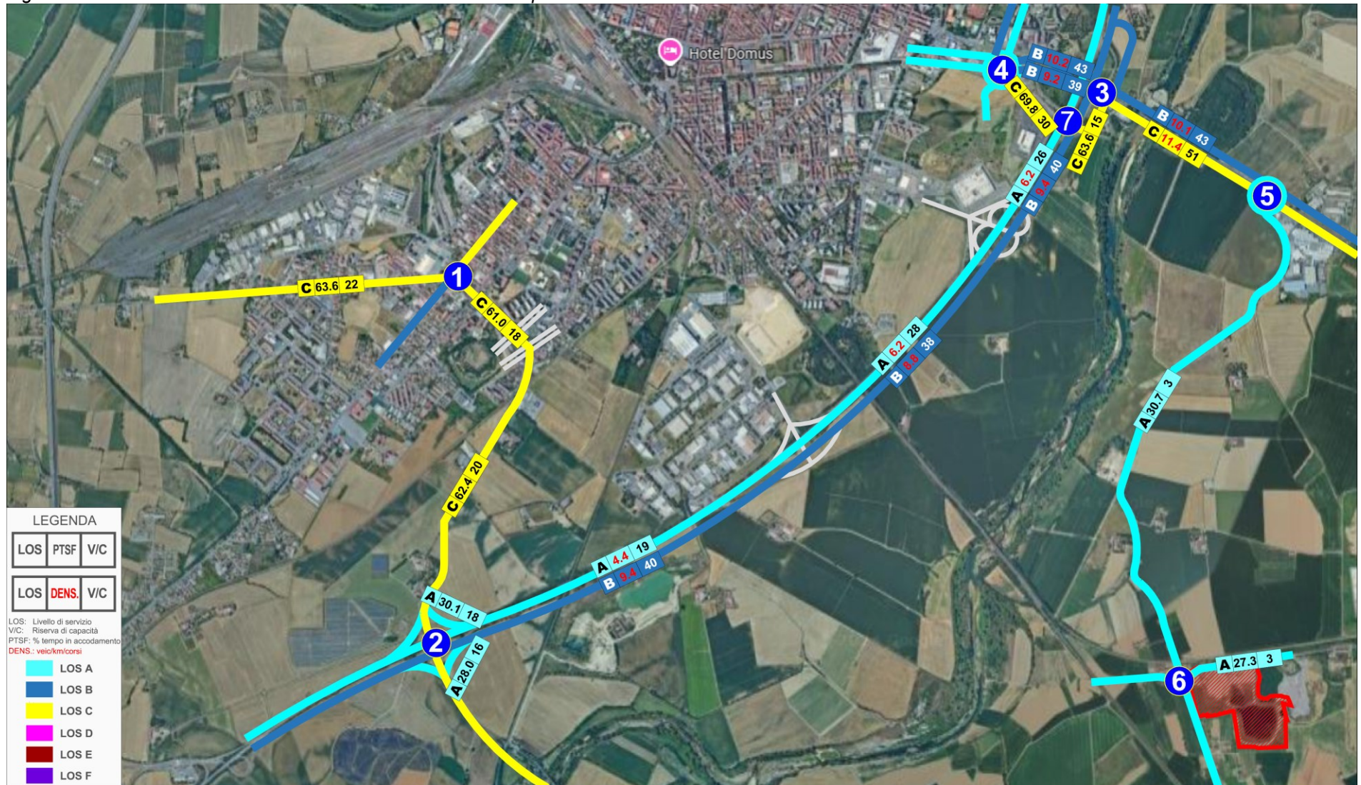
Fig. 41 – Livelli servizio rete stradale – Scenario attuale ora di punta 15.30-16.30
