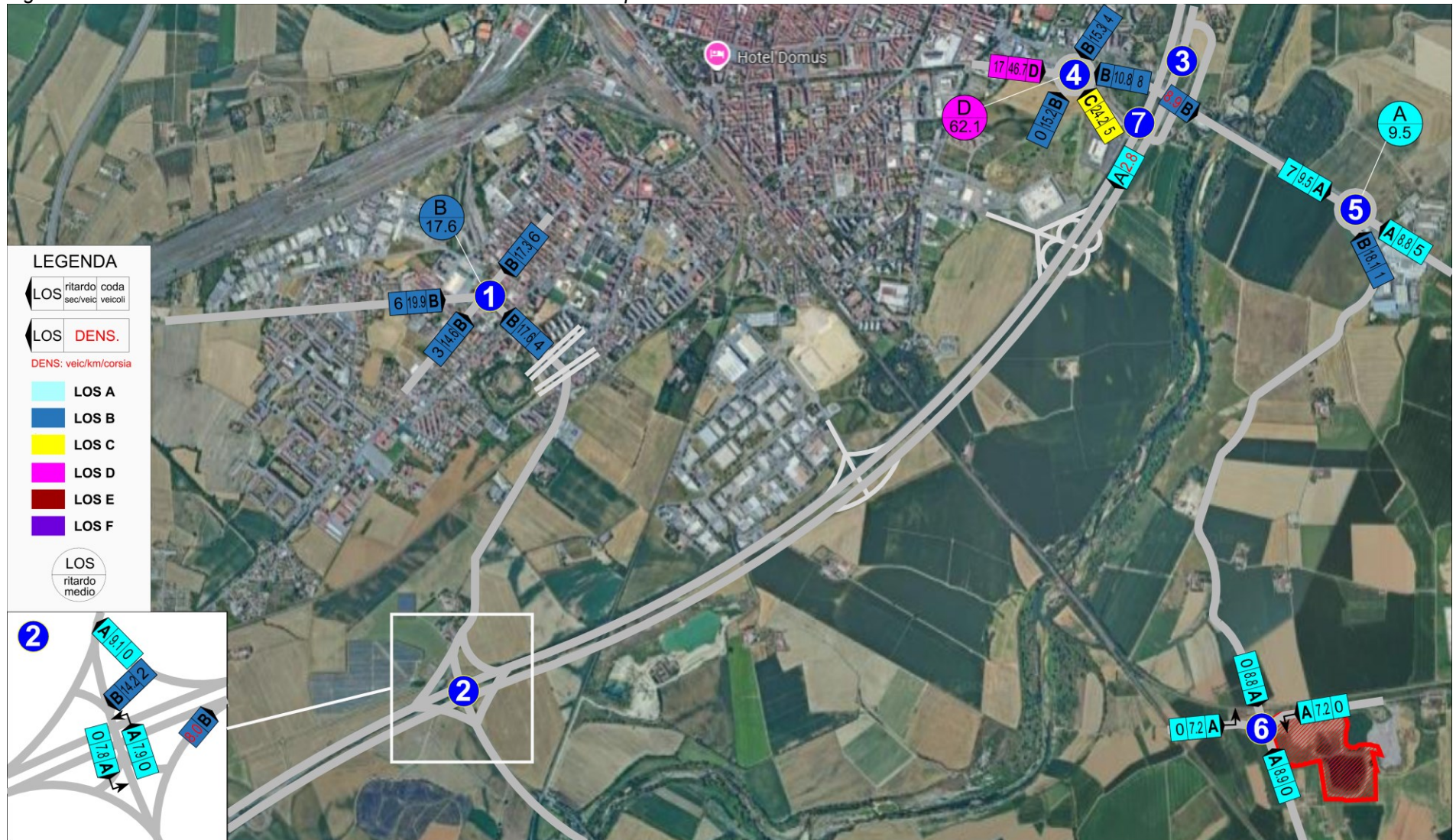
Fig 49 – Livelli servizio intersezioni stradali – Scenario attuale ora di punta 15.30-16.30
