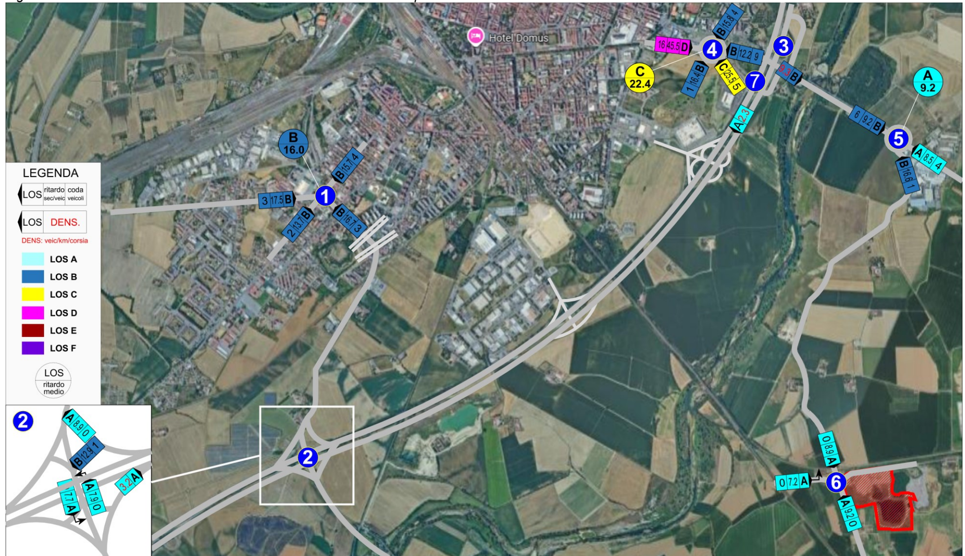
Fig 48 – Livelli servizio intersezioni stradali – Scenario attuale ora di punta 13.30-14.30
